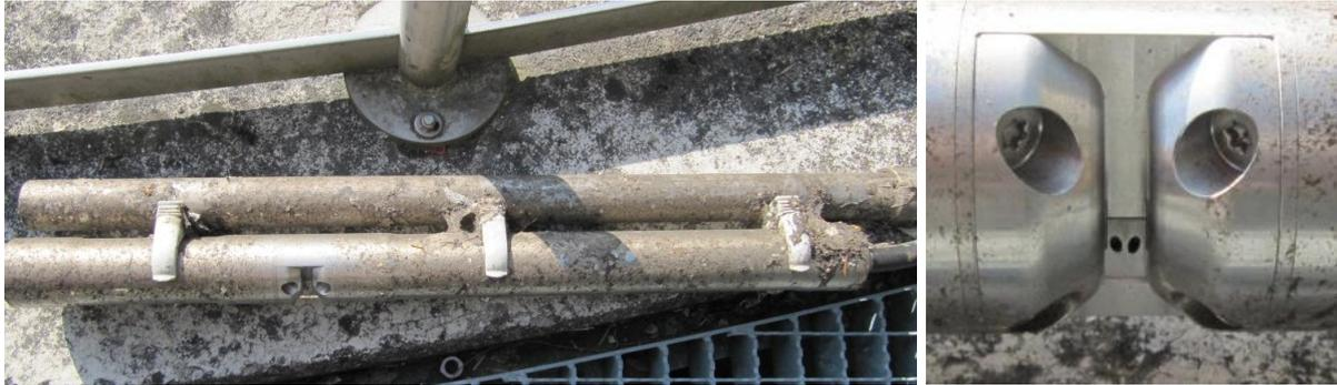
**Abbildung 44: Sonde nach mehrwöchigem Einsatz ohne manuelle Reinigung (links) und der Messschlitz der Sonde mit Reinigungsdüsen (rechts)**
